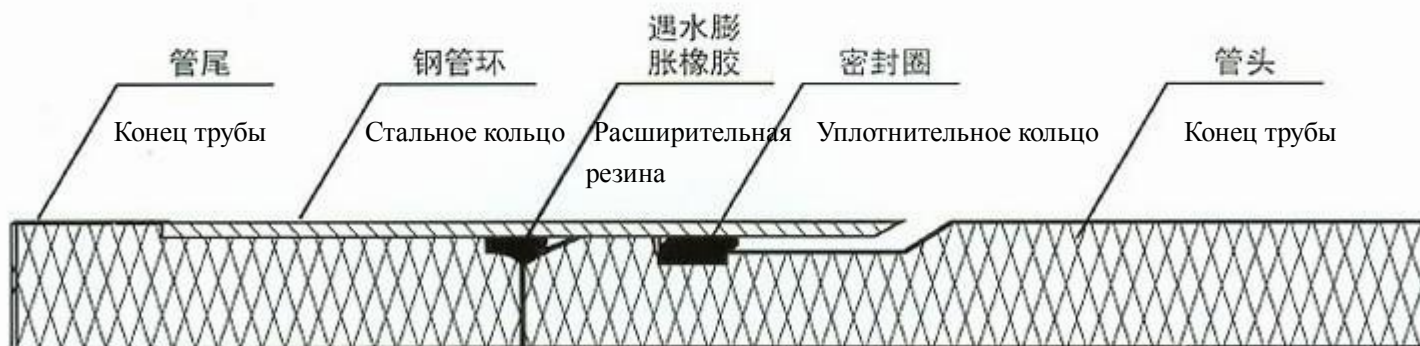
顶管连接示意图
